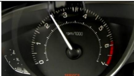
Na figura acima vemos que a rotação do motor está em 2400 rpm (aproximadamente), ou seja, o motor executa 2400 ciclos em um minuto. Dividindo por 60 (número de segundos em um minuto), descobrimos que o motor executa  $2400 / 60 = 40$  ciclos a cada segundo (ou seja, 40 Hz).
